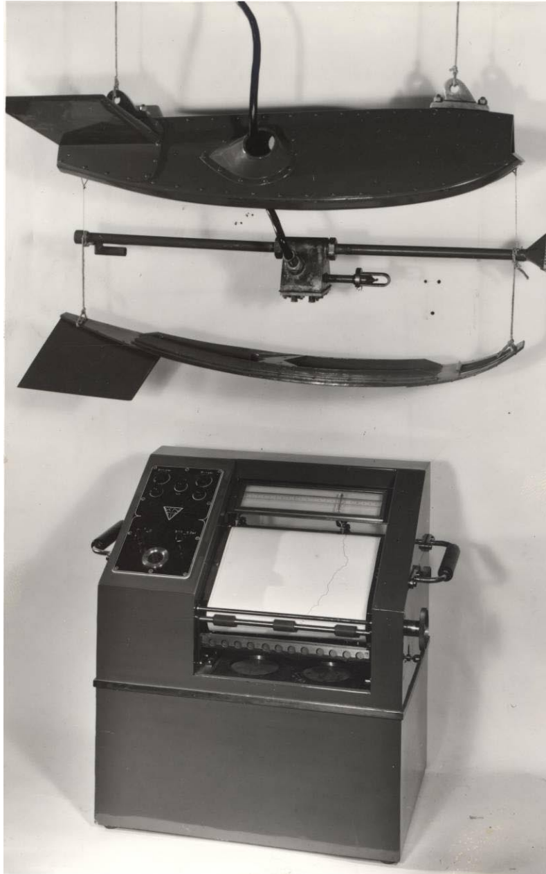
"Dorrestein-vis" met registratieapparaat. Bron: (2)
